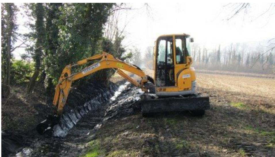
Figure 1: Faucardage mécanique
